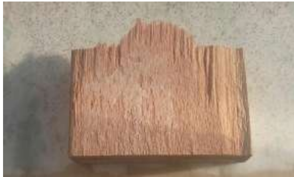
Figura 9. Corpo de prova com ruptura mista
