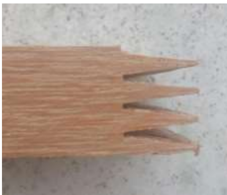
Figura 6. Detalhe dos dentes cortados no corpo de prova.
