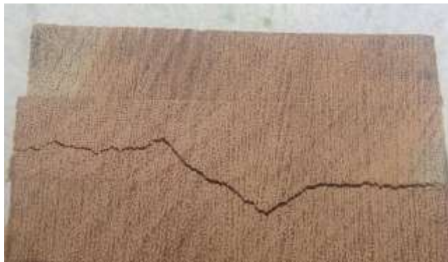
Figura 10. Direção de uma ruptura mista em um corpo de prova
