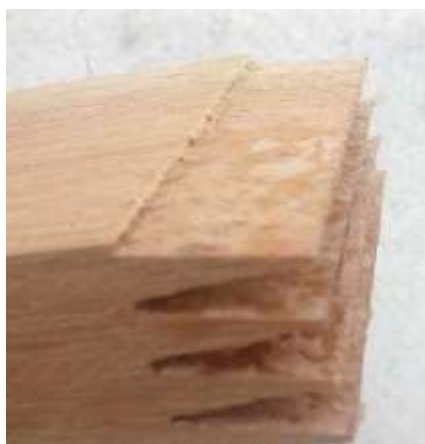
Figura 8. Corpo de prova com ruptura na linha de cola
