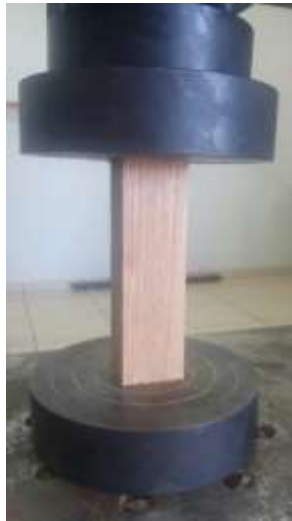
Figura 4. Ensaio de corpo de prova à compressão paralela às fibras
