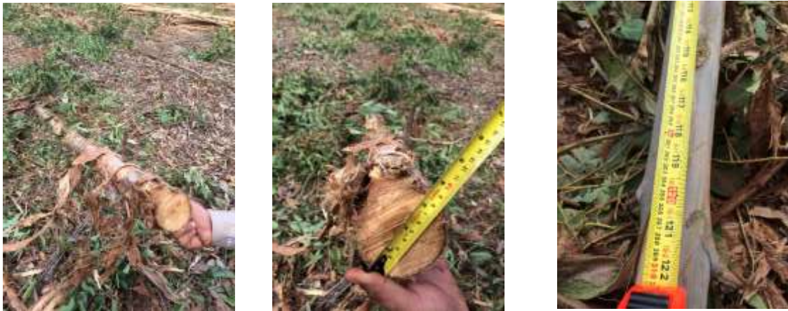
Figura 3 – Procedimento técnicos para mensuração das toras de resíduo.
