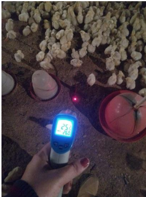
Figura 2. Termômetro medindo temperatura da cama abaixo do recomendável.
