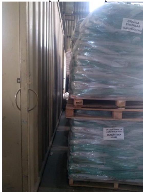
Figura 7. Armazenamento de matéria prima, respeitando o espaçamento entre paredes.
