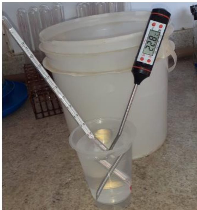
Figura 19: Aferição de termômetro com o equipamento de referência.
