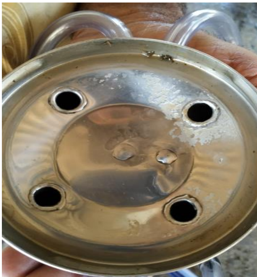
Figura 27: Coletor inox com resíduos de leite aderidos.
