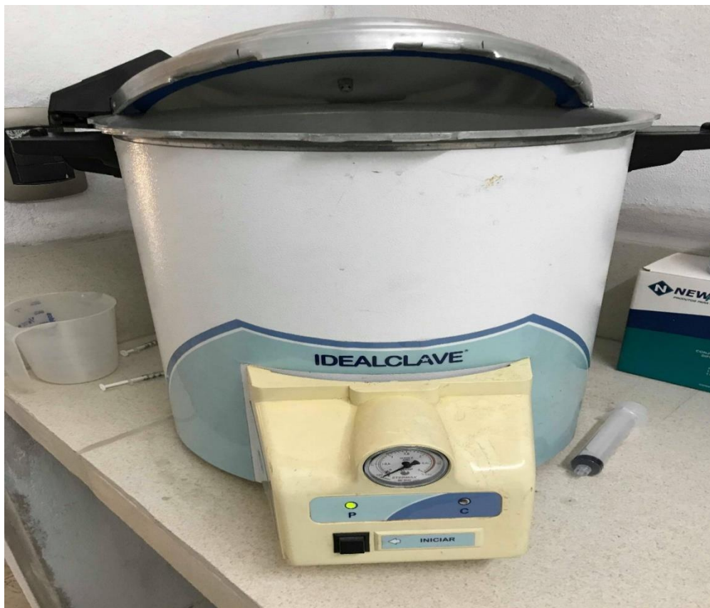
Figura 4: Autoclave utilizada para esterilização de sonda uterina
