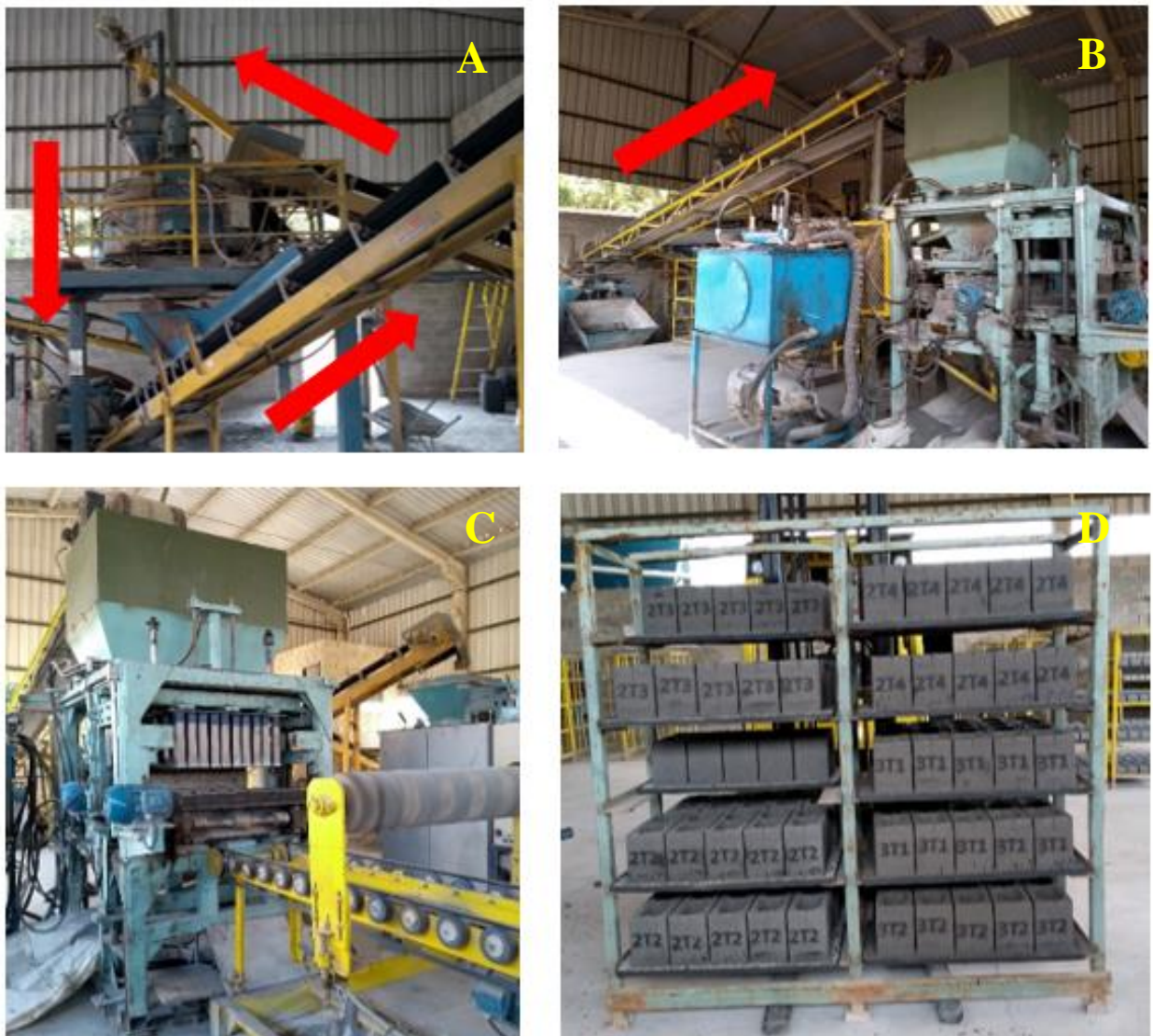
Figura 1 – Sequência de produção do bloco de concreto.
