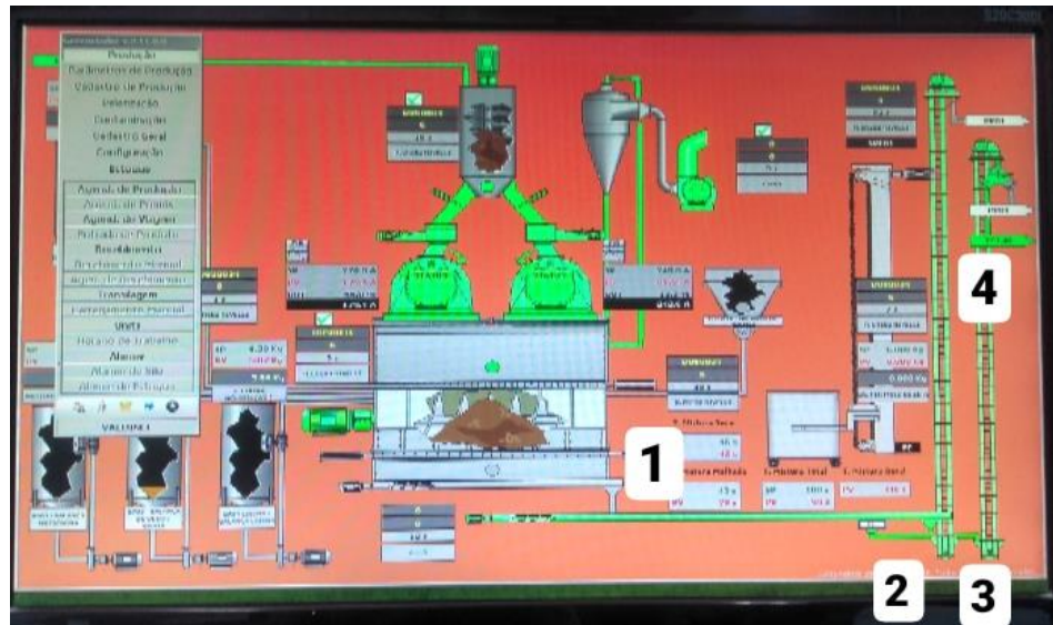
Figura 6. Esquema do sistema de mistura da Fábrica de Rações Rivelli Alimentos S/A.
