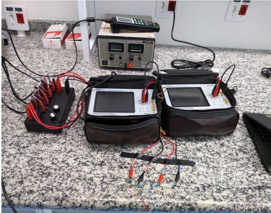
Figura 16: Padrões de calibração calibrando múltiplos sensores
