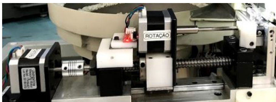
Figura 3.10 – Sistema de Fuso com Motor de Passo para Deslocamento Linear
