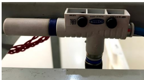
Figura 3.25 – Micro Gerador de Vácuo Utilizado para Sugar a Ponteira na Bainha
