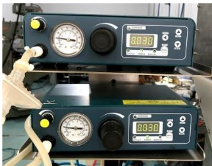
Figura 3.6 – Dispensers de Cola com Regulagem Precisa de Tempo de Despejamento e Quantidade
