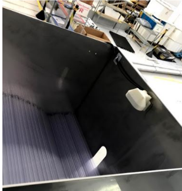
Figura 3.13 – Sensor para Medição de Nível do Reservatório de Bainhas
