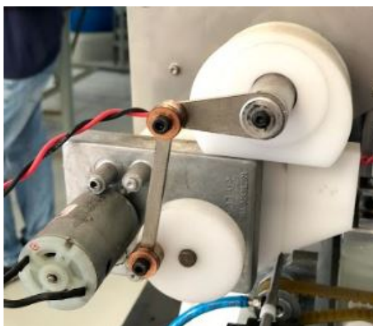
Figura 3.12 – Motor DC com Caixa de Redução de Alto Torque
