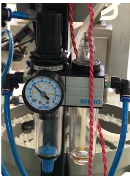
Figura 3.29 – Válvula Reguladora de Pressão do Ar Utilizado na Máquina
