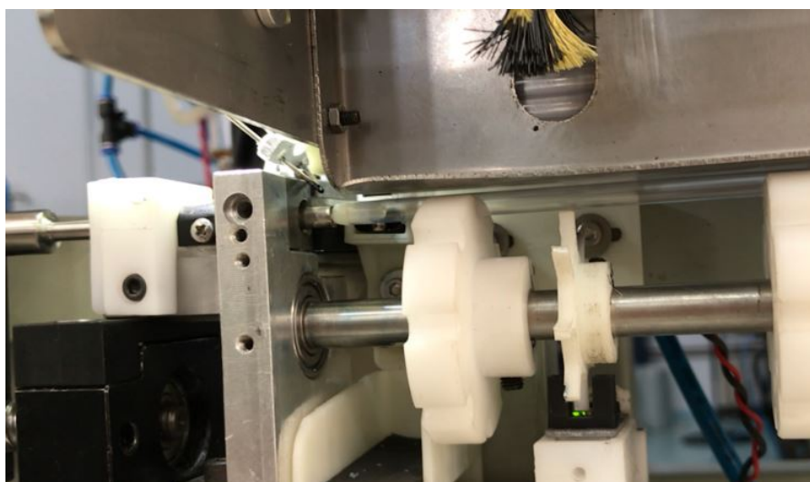
Figura 3.27 – Encaixe da Ponteira na Bainha por Meio do Vácuo
