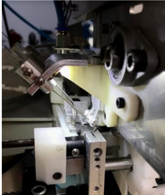
Figura 3.7 – Conjunto de 2 Agulhas com Regulhagem e Direcionamento da Colagem
