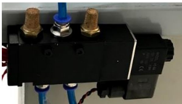
Figura 3.28 – Válvula Pneumática para Acionar o Gerador de Vácuo
