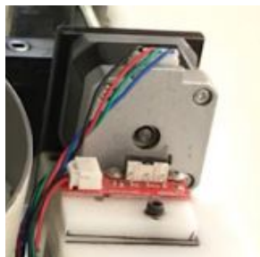
Figura 3.17 – Sensor Fim de Curso para os Motores de Passo
