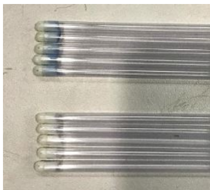
Figura 4.5 – Comparação das Ponteiras Com Cola de Coloração Azul Com Cola Incolor para Identificação de Falha no Processo
