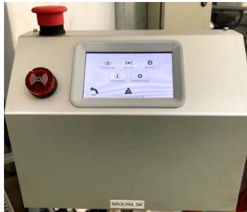
Figura 3.4 – Painel IHM com o Botão de Emergência e Sinalizador Sonoro Pulsante
