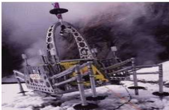
Figura 2 - Robô utilizado na exploração do interior de um vulcão situado na Antártida
