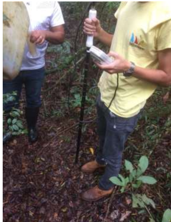
Figura 2 – a) Tubo de acesso para monitoramento. b) Sonda Profile Probe PR2/6. Fonte: Do autor (2019).
