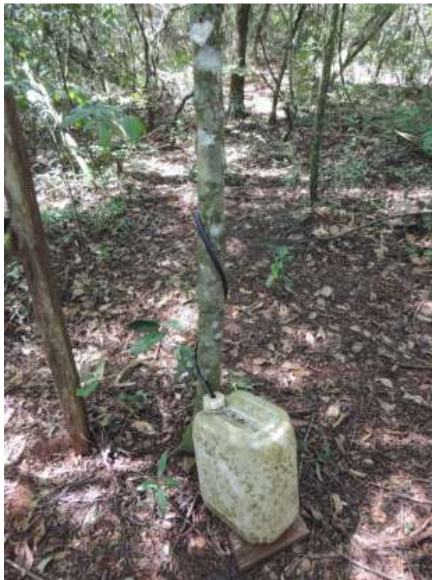
Figura 4 – Recipiente coletor utilizado no escoamento no tronco na FESM. Fonte: Do autor (2019).
