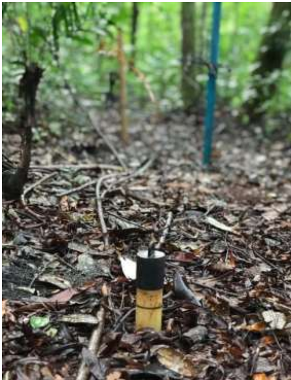
Figura 2 – a) Tubo de acesso para monitoramento. b) Sonda Profile Probe PR2/6. Fonte: Do autor (2019).
