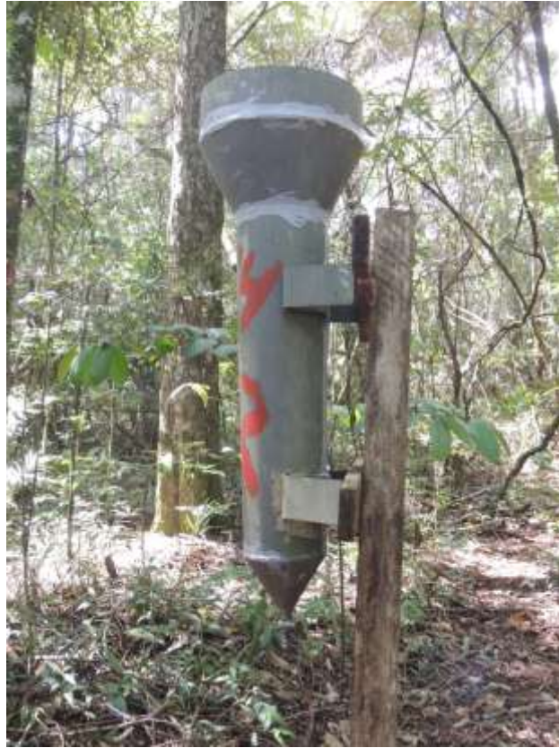
Figura 3 – Pluviômetro instalado no interior da FESM. Fonte: Do autor (2019).
