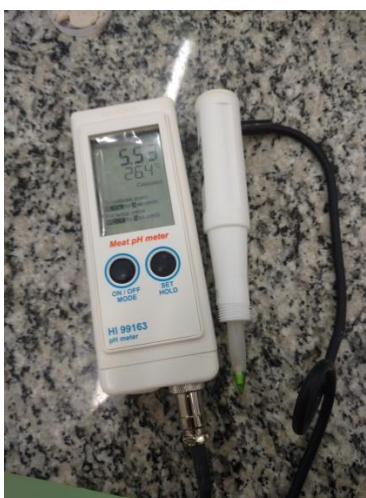
Figura 7– Aparelho utilizado para medição do pH (pHmetro portátil).
