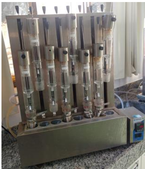
Figura 4- Extrator de Soxhlet utilizado na determinação do extrato etéreo.
