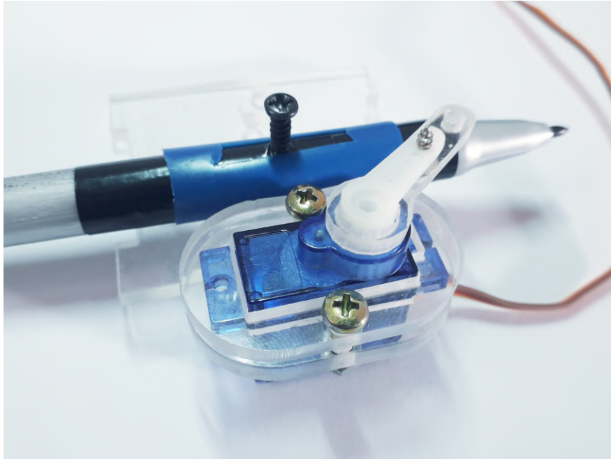
Figura 4.10 – Caneta e servomotor fixados lado a lado
