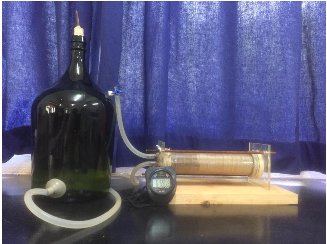
Figura 1 — Frasco de Mariotte e coluna de acrílico utilizados no ensaio de infiltração horizontal.
