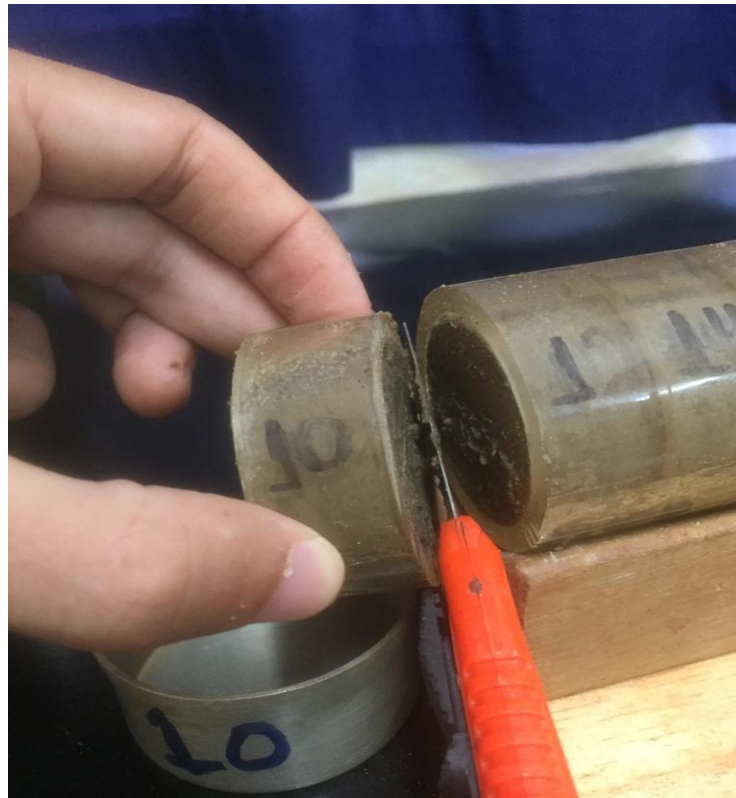
Figura 2 — Detalhe da separação dos anéis com solo da coluna horizontal.
