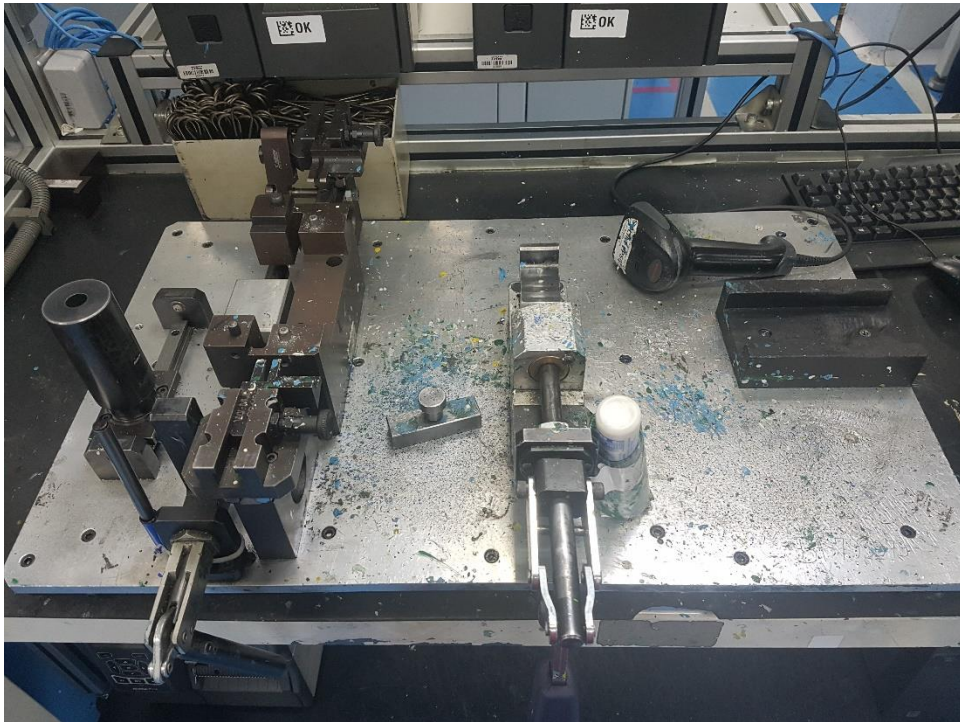
Figura 19 - Dispositivo para análise de inspeção manual da coluna da direção elétrica.
