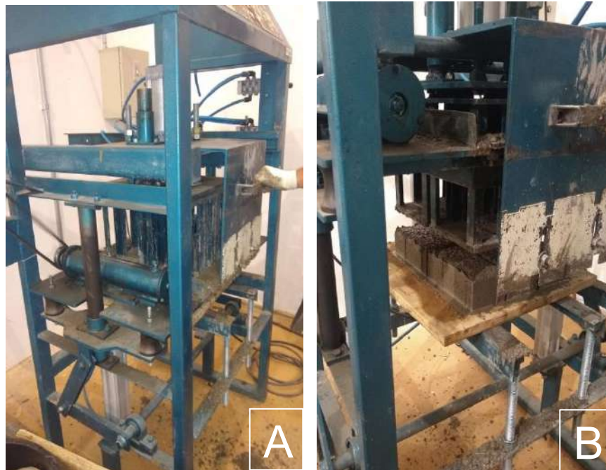
Figura 3: Processo de prensagem e desenformagem dos blocos.
