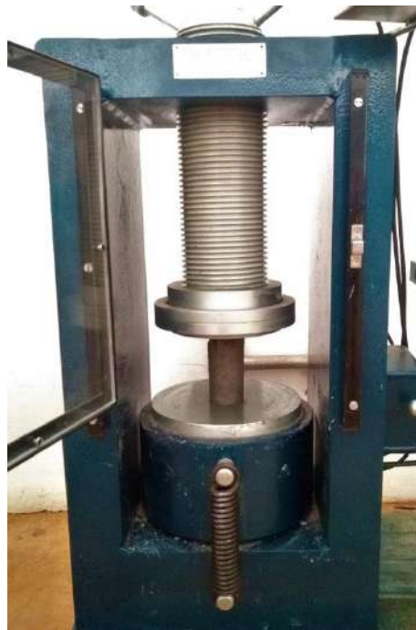
Figura 2: Máquina de ensaio hidráulica manual utilizada para teste de compressão utilizado no ensaio de pozolanicidade.
