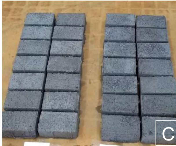
Figura 4: Blocos de concreto durante o processo de cura em temperatura ambiente.
