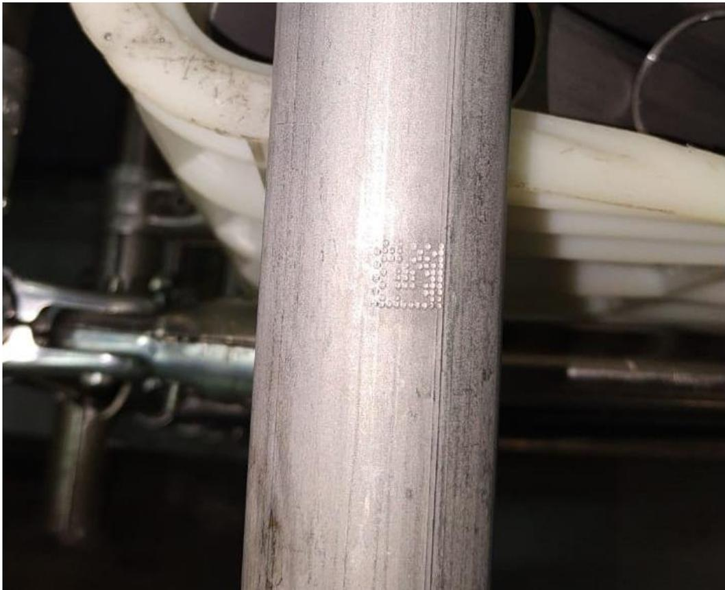
Figura 6 – Código DMC gravado no tubo do amortecedor
