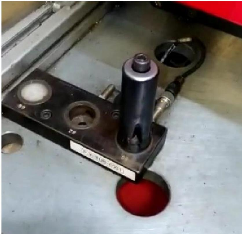
Figura 10 – Suporte detector de presença das punções.
