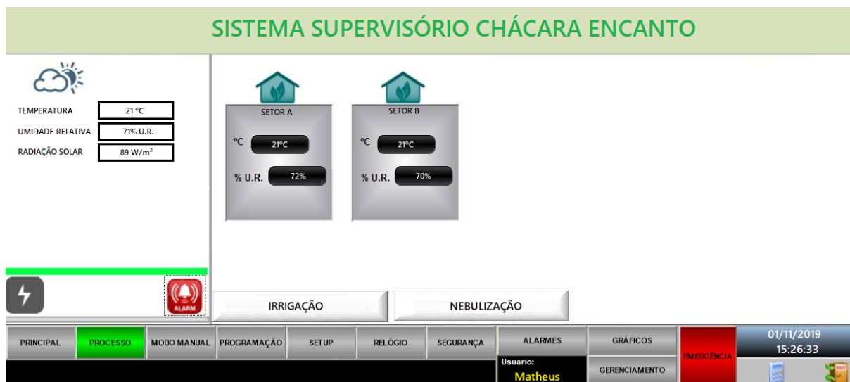
Figura 4.10 – Exemplo de Sistema Supervisório
