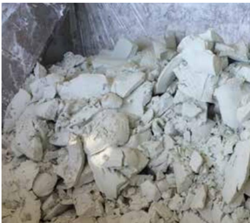
Figura 9: Pó de vidro gerado no processo de tratamento da água de lapidação realizado na ETAL (Estação de tratamento de água de lapidação, é gerada uma massa pastosa, denominada pó de vidro.
