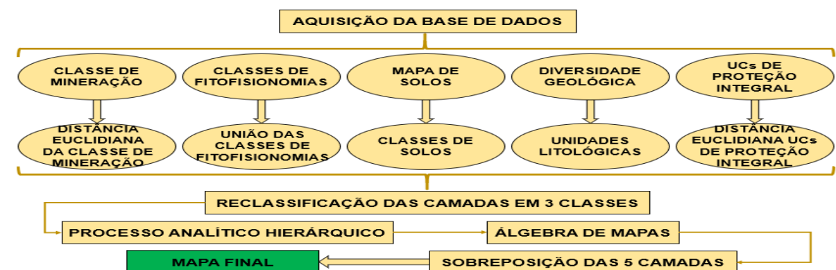
Figura 3 – Fluxograma detalhando os principais passos para a avaliação da vulnerabilidade ambiental à exploração minerária na APA SUL RMBH por meio de análise multicritério.
