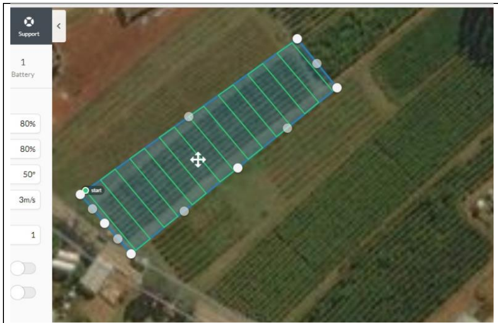
Figura 1- Layout plano de voo no aplicativo Drone Deploy instalado no smartphone.
