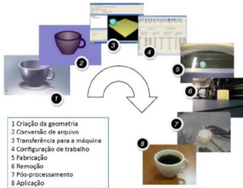
Figura 25 - Processo de produção por manufatura aditiva.
