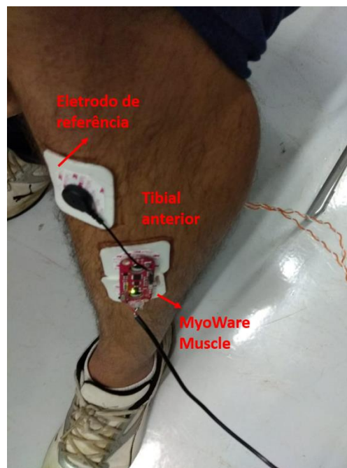
Figura 59 - Myoware Muscle e eletrodos posicionados para a captação do pulso elétrico do músculo Tibial inferior.
