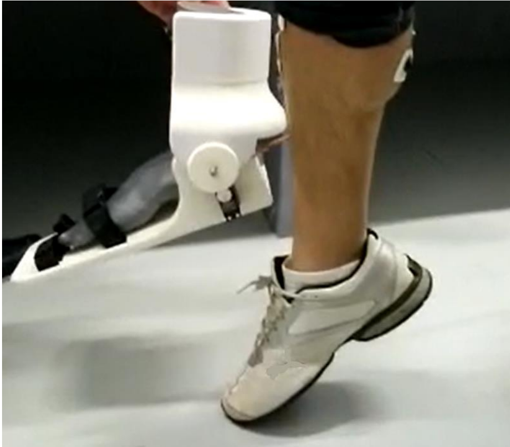
Figura 64 - Órtese realizando a flexão plantar de acordo com o movimento prescrito pelo tênis.
