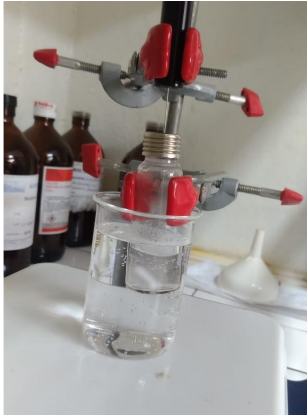
Figura 9: Montagem do esquema de extração por SPME manual.
