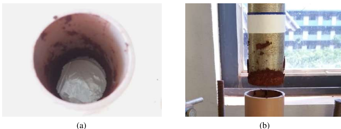
Figura 4.6 – Retenção de massa da mistura na compactação dos corpos de prova: (a) no tubo de PVC e (b) na prensa fixa.
