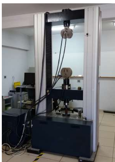
Figura 3.9 – Execução do ensaio de resistência à compressão simples: submissão ao esforço mecânico em (a) prensa automática até a (b) ruptura do CP.
