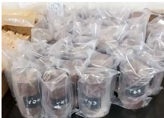
Figura 3.8 – Acondicionamento dos corpos de prova de solo e solo-cal.
