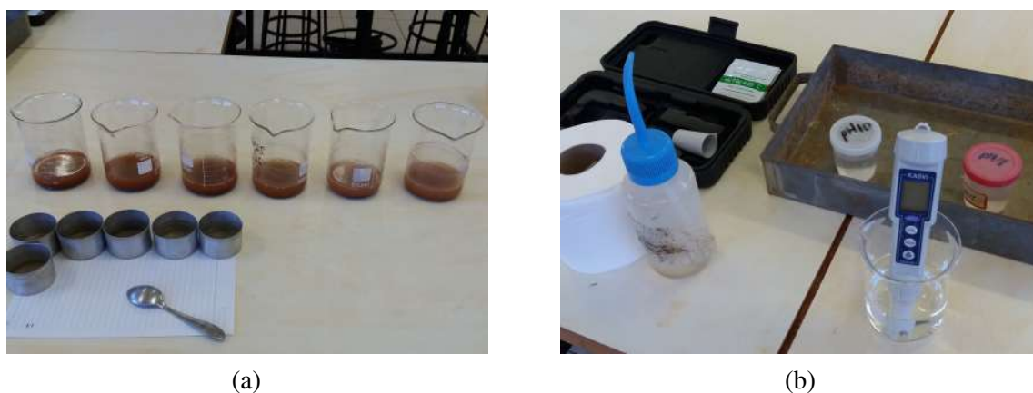
Figura 3.5 – Metodologia experimental de dosagem por pH: (a) soluções aquosas de solo-cal, cujo pH será aferido por (b) pHmetro portátil.
