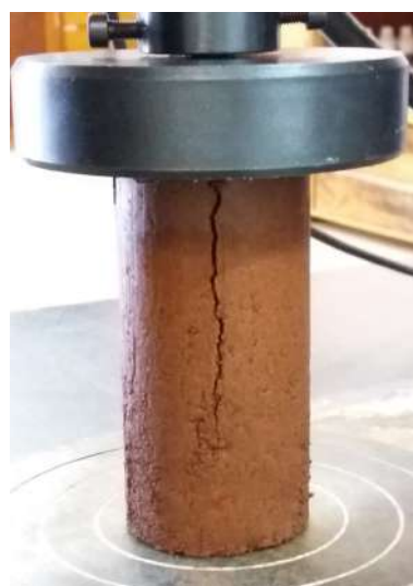
Figura 3.9 – Execução do ensaio de resistência à compressão simples: submissão ao esforço mecânico em (a) prensa automática até a (b) ruptura do CP.
