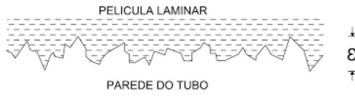
Figura 1 - Rugosidade da parede interna de um tubo.
