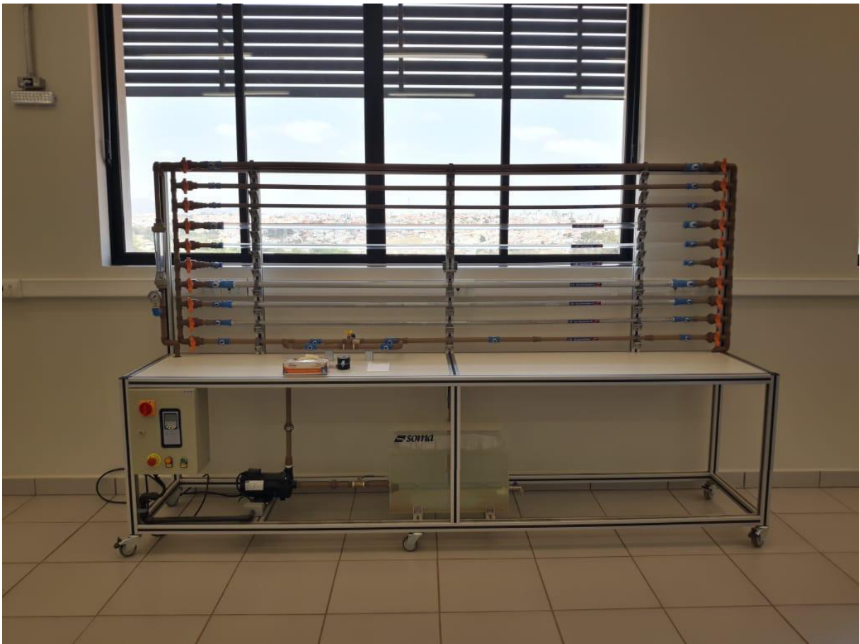
Figura 13 – Módulo didático para análise de perda de carga.
