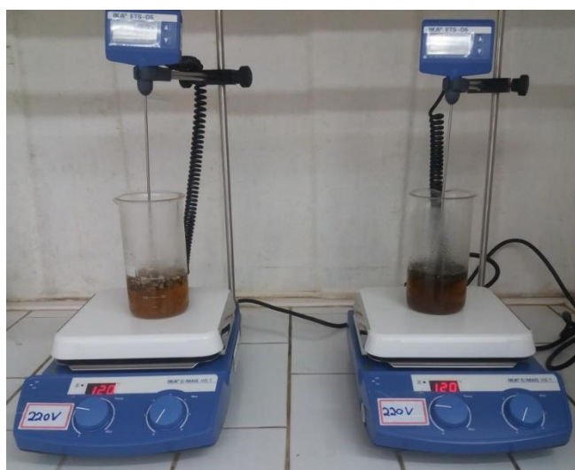
Figura 4 – Esquema para realização do ciclo de lavagens das partículas de Cacto.
