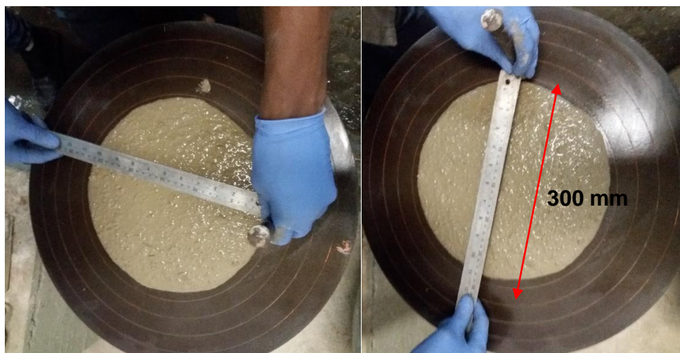
Figura 5 - Ensaio de espalhamento ( flow table test ).
