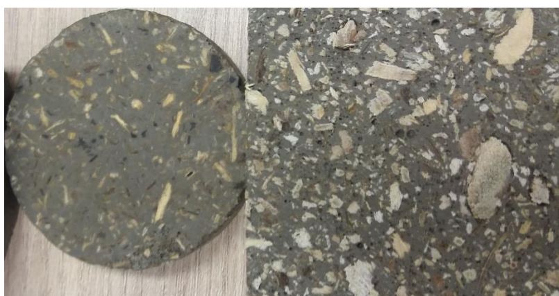
Figura 8 – Homogeneidade dos bioconcretos. Vista do topo de um CP (à direita) e vista interna (corte transversal) (à esquerda).
