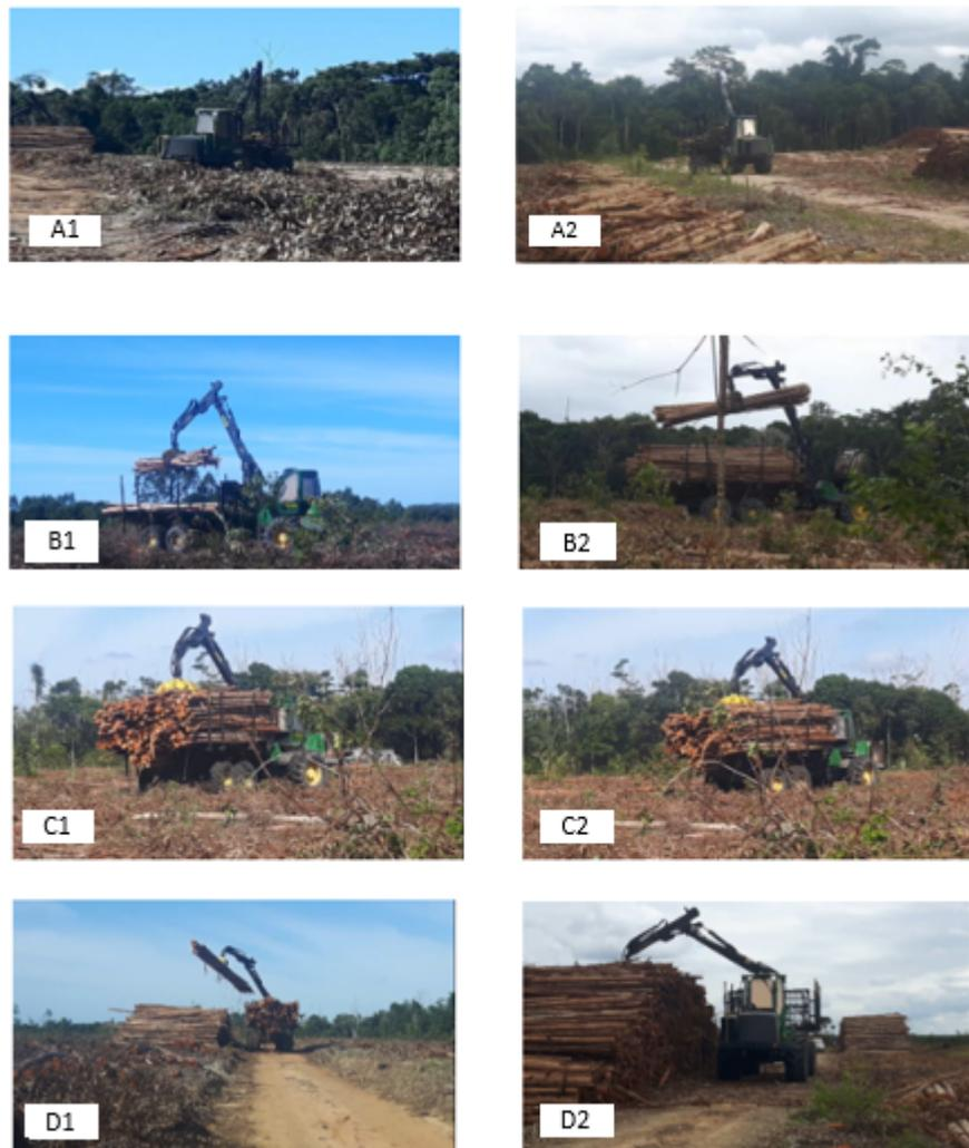
Etapas: A1 e A2) Deslocamento vazio; B1 e B2) Carregamento; C1 e C2) Deslocamento carregado; D1 e D2) Descarga.
