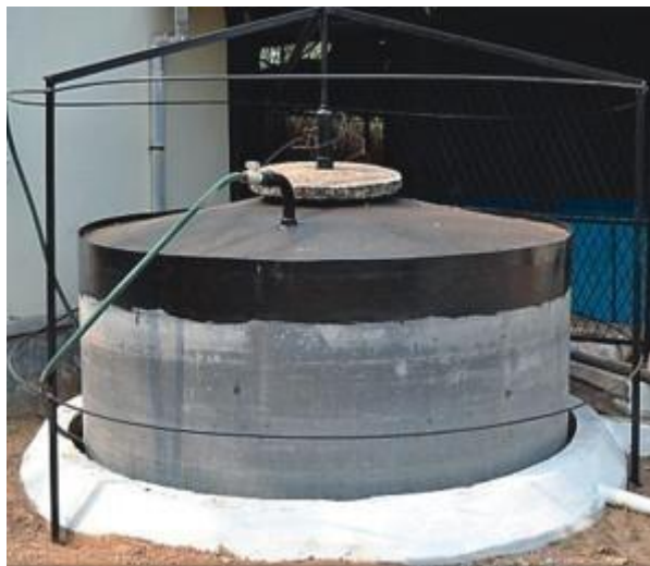
Figura 3 – Desenho esquemático de um biodigestor indiano.
