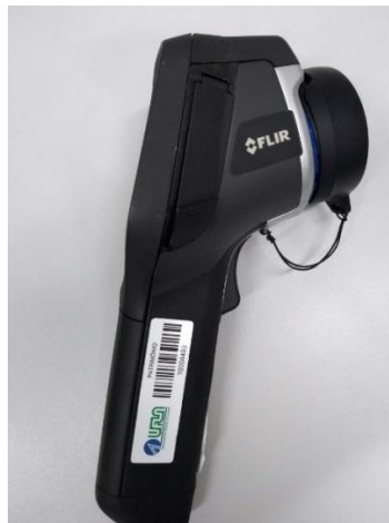
Figura 12 – Câmera termográfica FLIR modelo E50 utilizada nas análises térmicas.
