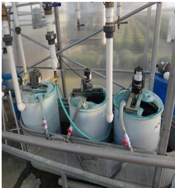
Figura 14 - Barril de armazenamento, injetores e motor para agitação
