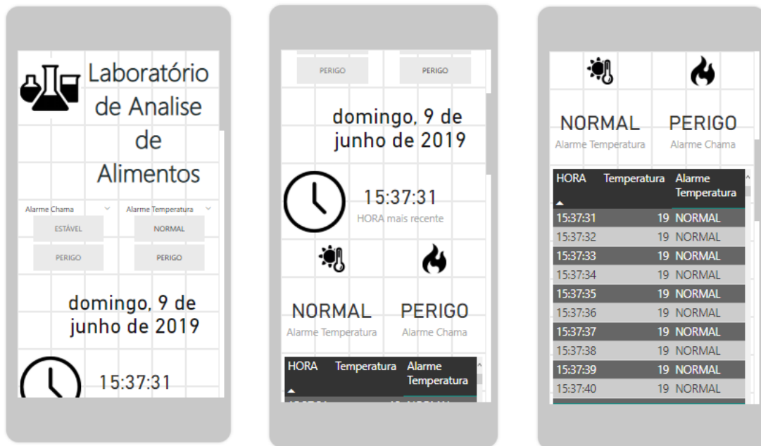
Figura 14 – Relatório exibido no celular a partir da aplicação do software PowerBI com os valores coletados dos sensores e seus respectivos indicadores.
