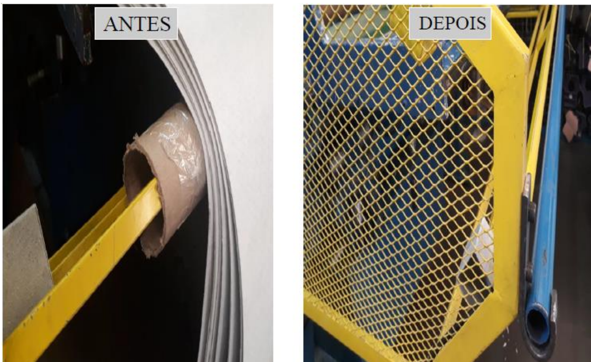
Figura 5.2.1 - Proposta de kaizen balancim de ponte hidráulico
