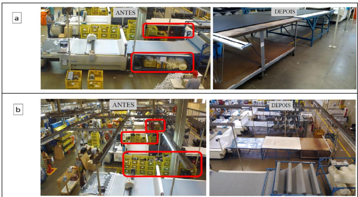
Figura 5.1.3 - Mudanças no setor. a) retirada de material desnecessário. b) organização do espaço.
