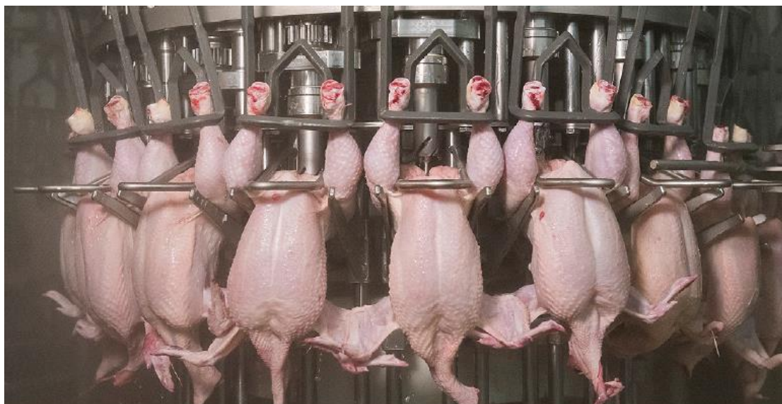
Figura 08- Equipamento de extração automática da cloaca. Fonte: Meyn Food Processing Technology B.V. (2018).
