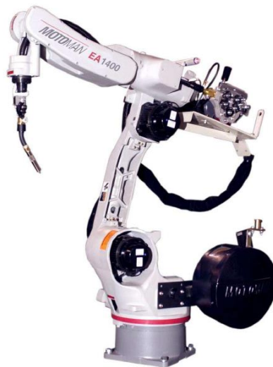
Figura 12 - Robô Motoman com ponta de solda por arco ao punho como efetuador.
