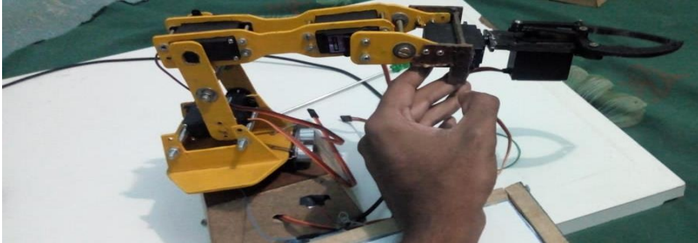
Figura 47 - Protótipo montado com seus 5 Graus de Liberdade e a garra
