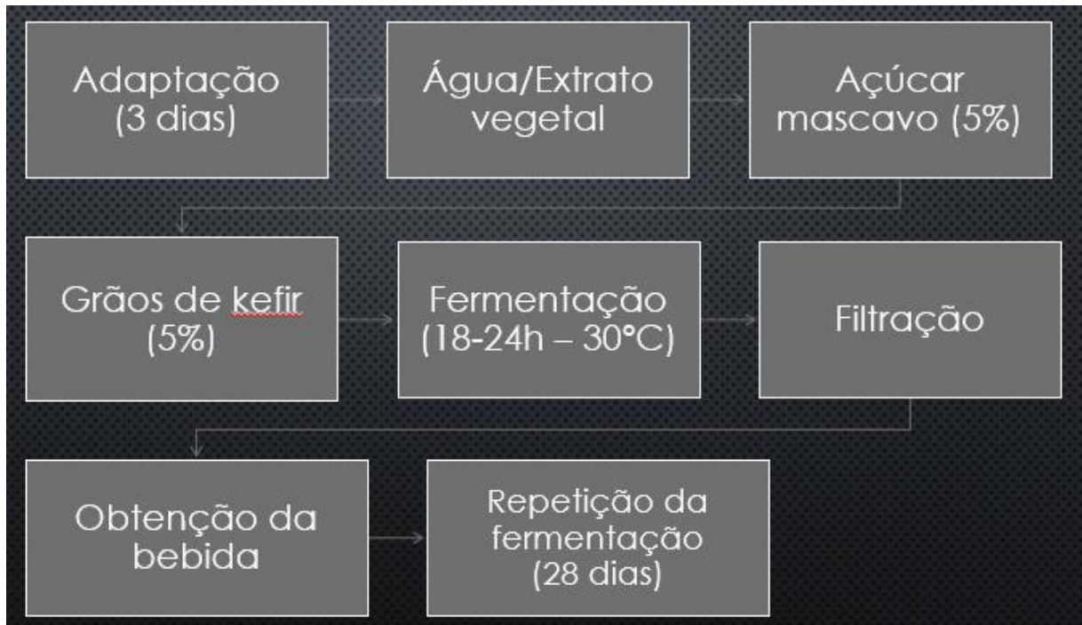
Figura 11. Fluxograma de produção da bebida fermentada de arroz com kefir
