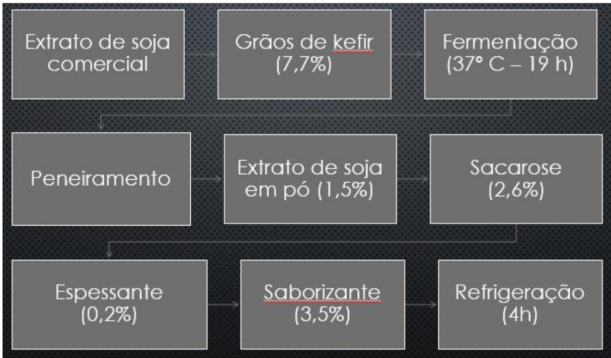
Figura 10. Fluxograma de produção da bebida fermentada de soja com kefir
