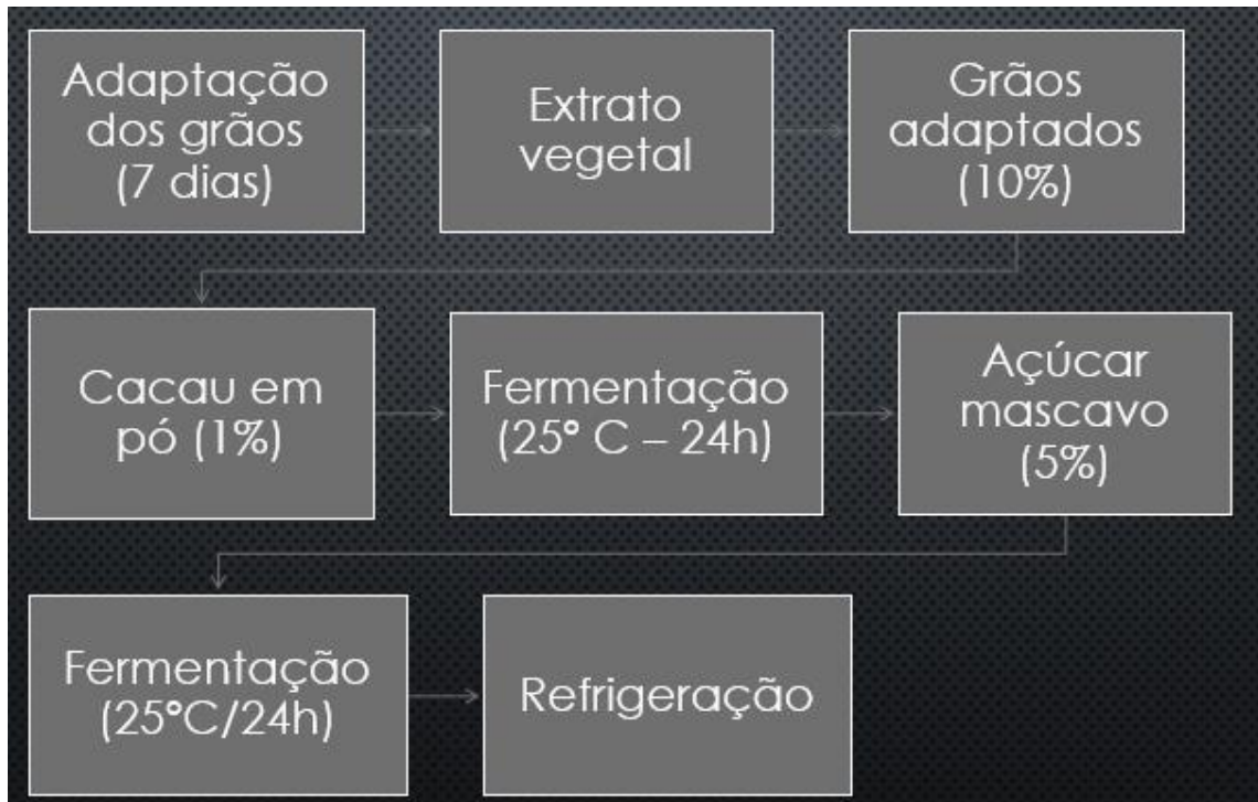
Figura 9. Fluxograma de produção da bebida de quinoa com kefir
