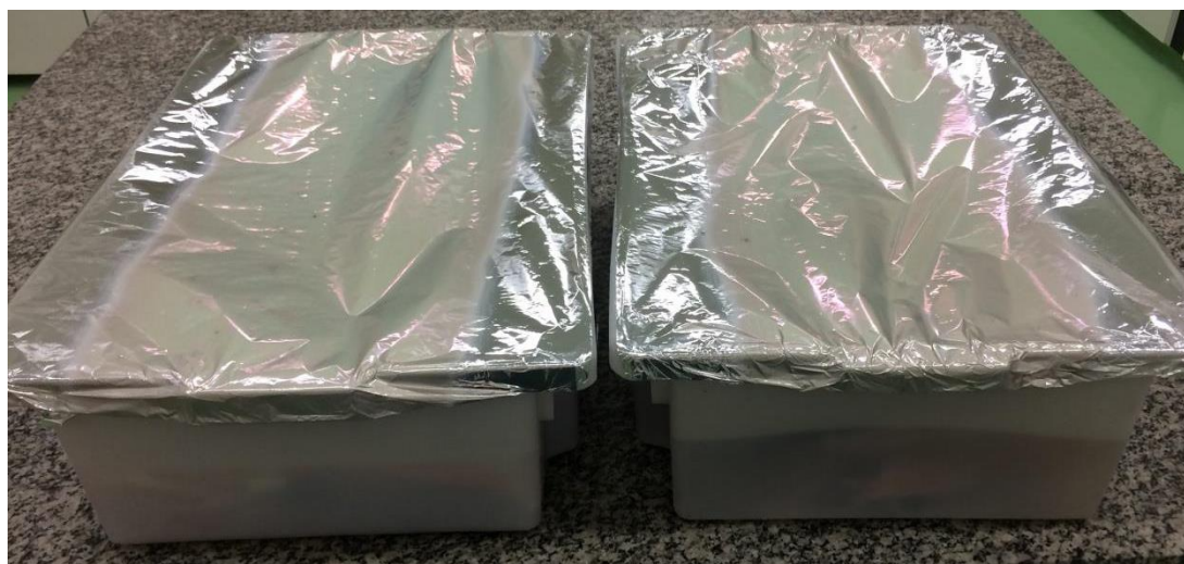
Figura 4 - Papel alumínio para impedir a penetração da luz.
