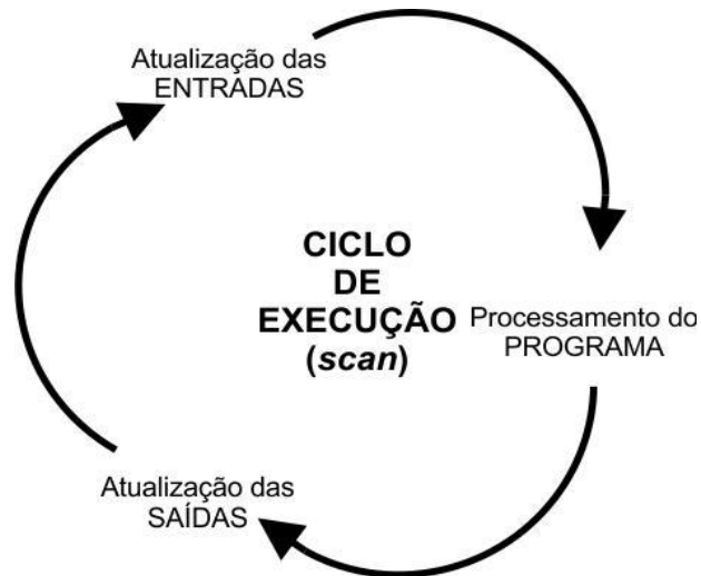
Figura 8 - Esquema do ciclo de atualização de um CLP
