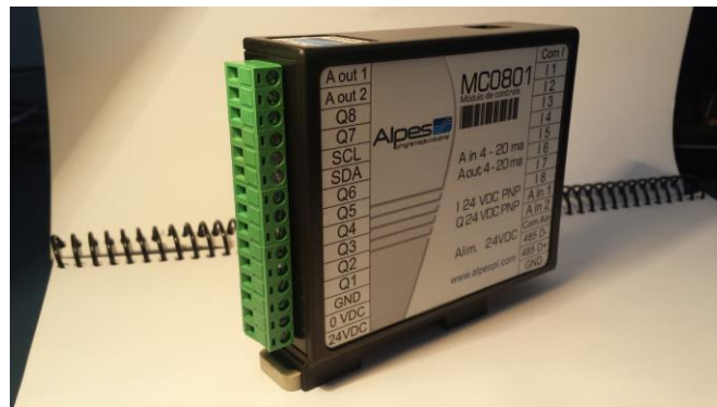
Figura 4 – Controlador Compacto MCO801 (Marca: Alpes PI)
