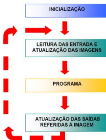
Figura 4 – Ciclo de processamento do CLP
