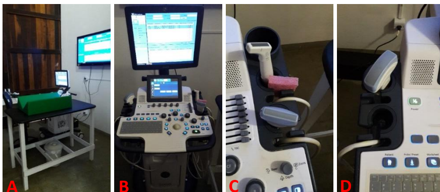
Figura 7 - Sala de Ultrassonografia do HV-UFPR, DPI; 7A – vista parcial, onde são realizados exames ultrassonográfico em período integral; 7B vista total – aparelho ultrassonográfico UltraSom LOGIQ F8 VET - GE; 7C – transdutor linear de 12,0 a 6,0MHz e microlinear L8-18i de 8,0 a 18,0MHz; 7D – transdutor convexo 4C de 2,0 a 5,5MHz. Fonte: Do autor (2019).
