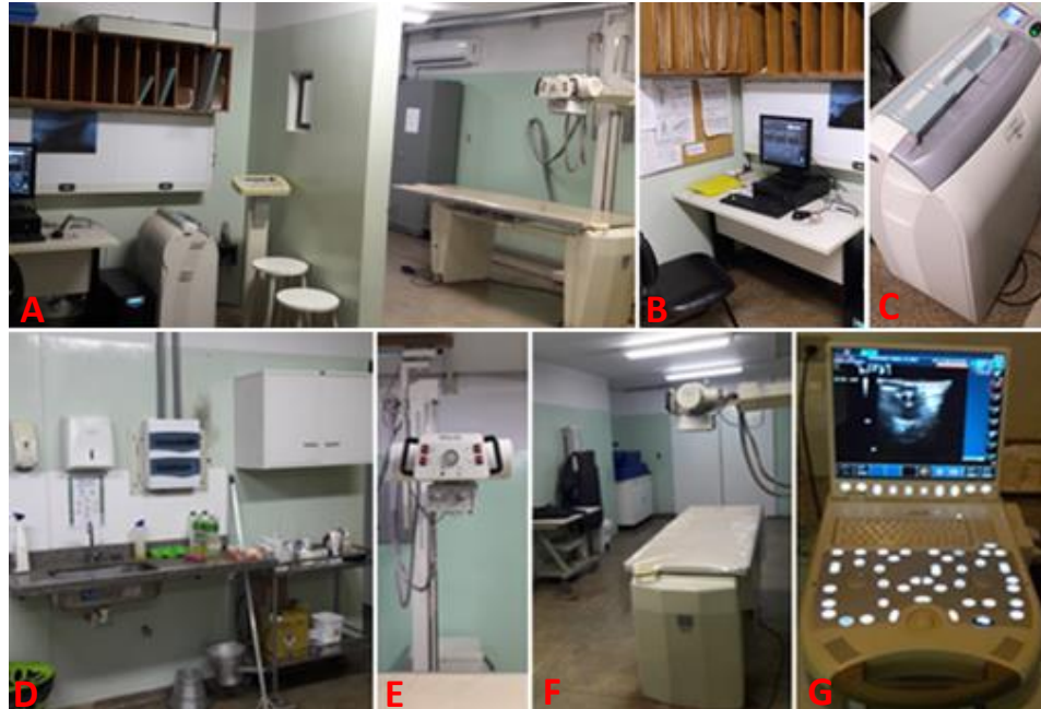
Figura 14 – Sala de Radiologia HV-EVZ/UFG, DPI; 14A – vista parcial, onde são realizados os exames radiográficos e a leitura dos cassetes; 14B – vista parcial, computador para leitura de cassetes; 14C – impressora FUJIFILM, FCR Capsula X; 14D – vista parcial pia com materiais auxiliares ao exame radiográfico; 14E e 14F aparelho de Raio-X VMI da marca Philips, de 500mA com mesa de altura ajustável e gaveta para cassetes; 17G – aparelho de ultrassonografia Esaote Mylab30 Vet, utilizado eventualmente para exames externos ao setor ou oftálmicos. Fonte: Do autor, 2019.
